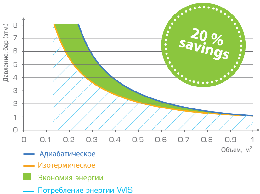
Ограниченное увеличение температуры в элементе сжатия компрессора только на 25°C
